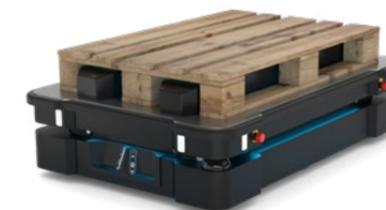
El **MiR1000** automatiza y optimiza el transporte interno de cargas pesadas y palés. Con una capacidad de carga de 1.000 kg, es el robot más potente de MiR, e incluso en entornos muy dinámicos es capaz de transportar cargas pesadas sin necesidad de medidas de seguridad exteriores.
